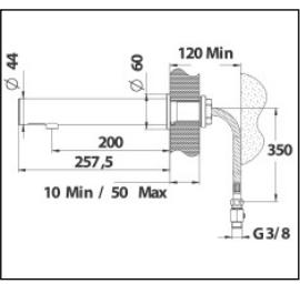
Sensor-AP-Wandarmatur, Messing, verchromt, mit starrem Auslauf, Luftsprudler; für kalt od. vorgemischtes Wasser, integrierte Sensorelektronik, Legionellenspülautomatik, externer Trafo (IP65; 83x55x60mm) mit IP68 Anschluß
